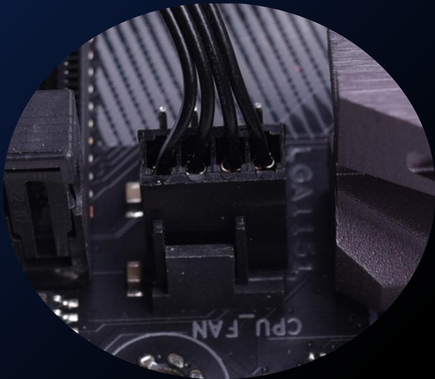
风扇供电线连接到主板的CPU-FAN接口
