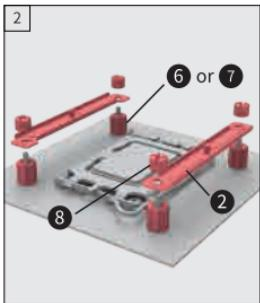
将Intel背板安装在主板的背面，主板正面依次安装LGA1700胶柱⑥或通用胶柱⑦、Intel支架，并用螺母固定。
