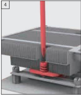
清洁CPU表面，涂好硅脂，然后将散热器安装在散热底座上。
