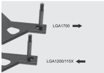
Intel背板支持LGA1700和LGA1200平台的安装，使用时，根据CPU和主板类型，将背板螺栓拨动到适合的位置即可进行安装。
