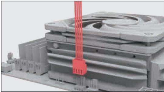
将风扇的4PIN接口连接到主板CPU-FAN接口，实现智能温控。
