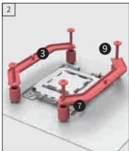
拆除主板散热底座，保留背板；然后依次安装支撑胶柱，AMD支架，AMD螺栓，拧紧固定。
